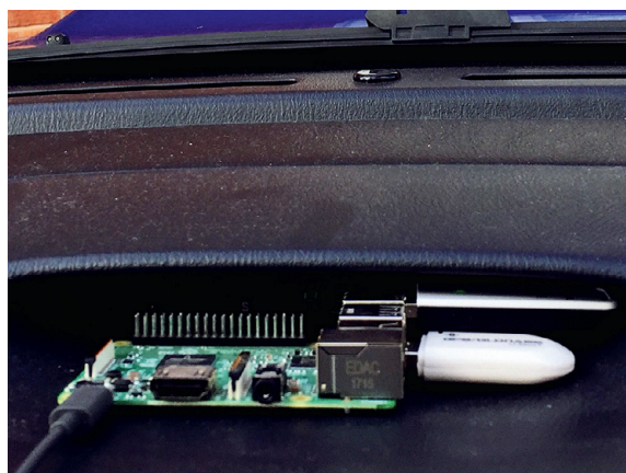
Смонтируйте Pi как можно выше, чтобы ничего не перекрывало обзор неба. Это улучшит прием GPS и Wi-Fi.
