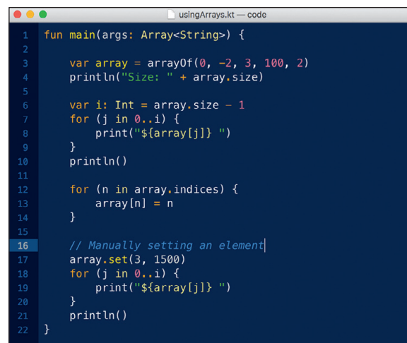
► Рис. 2. Код Kotlin из файла usingArrays.kt . В нем показано два способа доступа ко всем элементам массива: array , indices и array.size .
