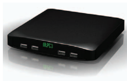
➤ Массивный корпус MintBox рассеивает тепло, и в шумном вентиляторе нужды нет.
