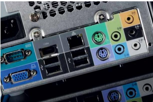
» Кард-ридер, два USB и mini-Firewire порты на передней панели компьютера. Сзади – Ethernet, четыре USB, стандартный Firewire, PS2 и аудио-порты.
